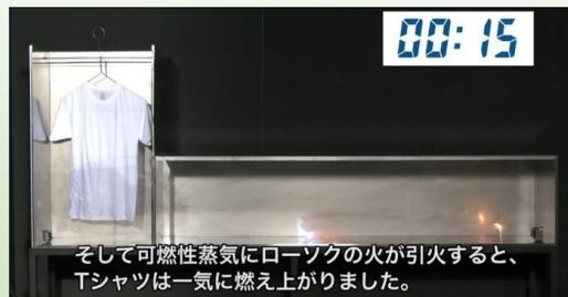
可燃性蒸気にローソクの火が引火し、Tシャツから流れてくる可燃性蒸気を伝い、炎がTシャツの方へ進みます。
