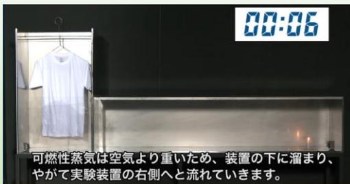
ガソリンを染み込ませたTシャツから可燃性蒸気が発生して下の方に溜まり、右側のローソクの方へ流れていきます。
