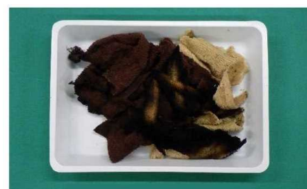
焼損したタオルの状況
